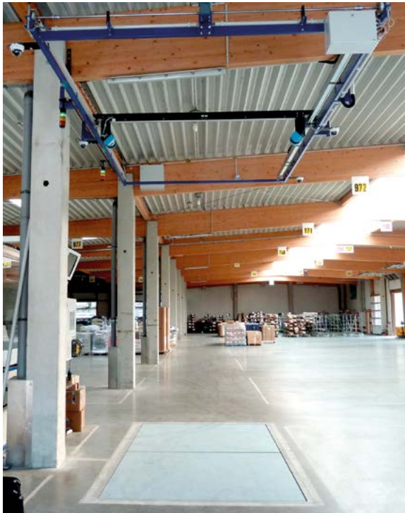
Volumentportal für die Erfassung von 2 Paletten mit Verbundwaage
