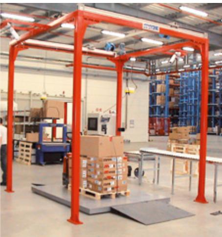
Volumenportal, Bodenwaage mit Auffahrrampe
