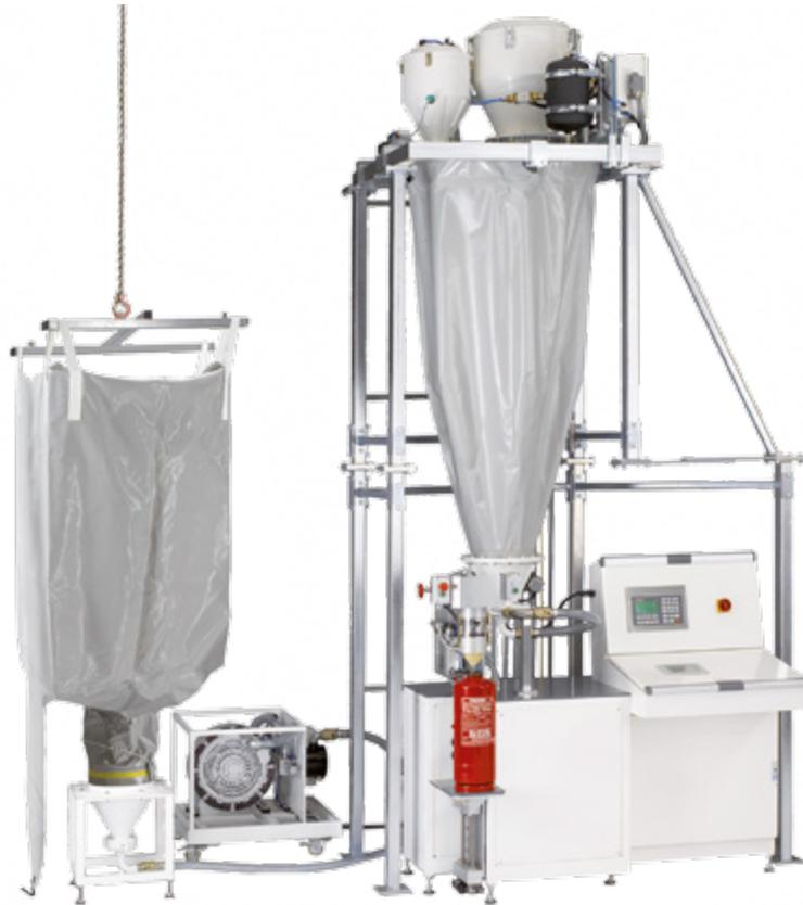
*Komplette Abfülldosieranlage für Feuerlöscher*
