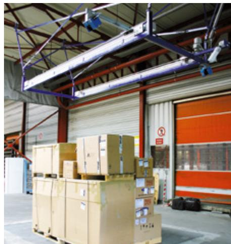
Deckenmodul Volumen, Bodenwaage eingebaut
