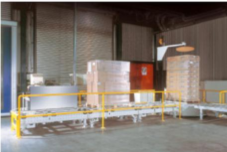
Durchlaufverwiegung mit Fördertechnik
