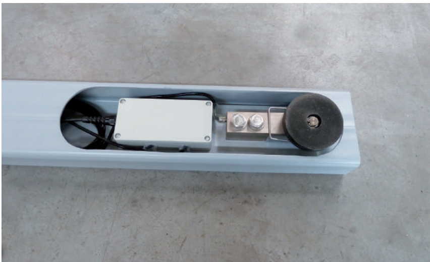
Wägezellen und Anschlusskasten sicher innerhalb der Konstruktion
