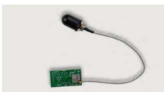
Modul mit externer Antenne für Edelstahl-Terminals 30xx
