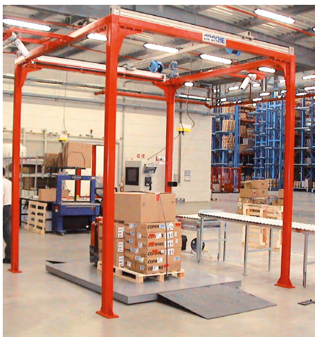
Volumenportal, Bodenwaage mit Auffahrrampe
