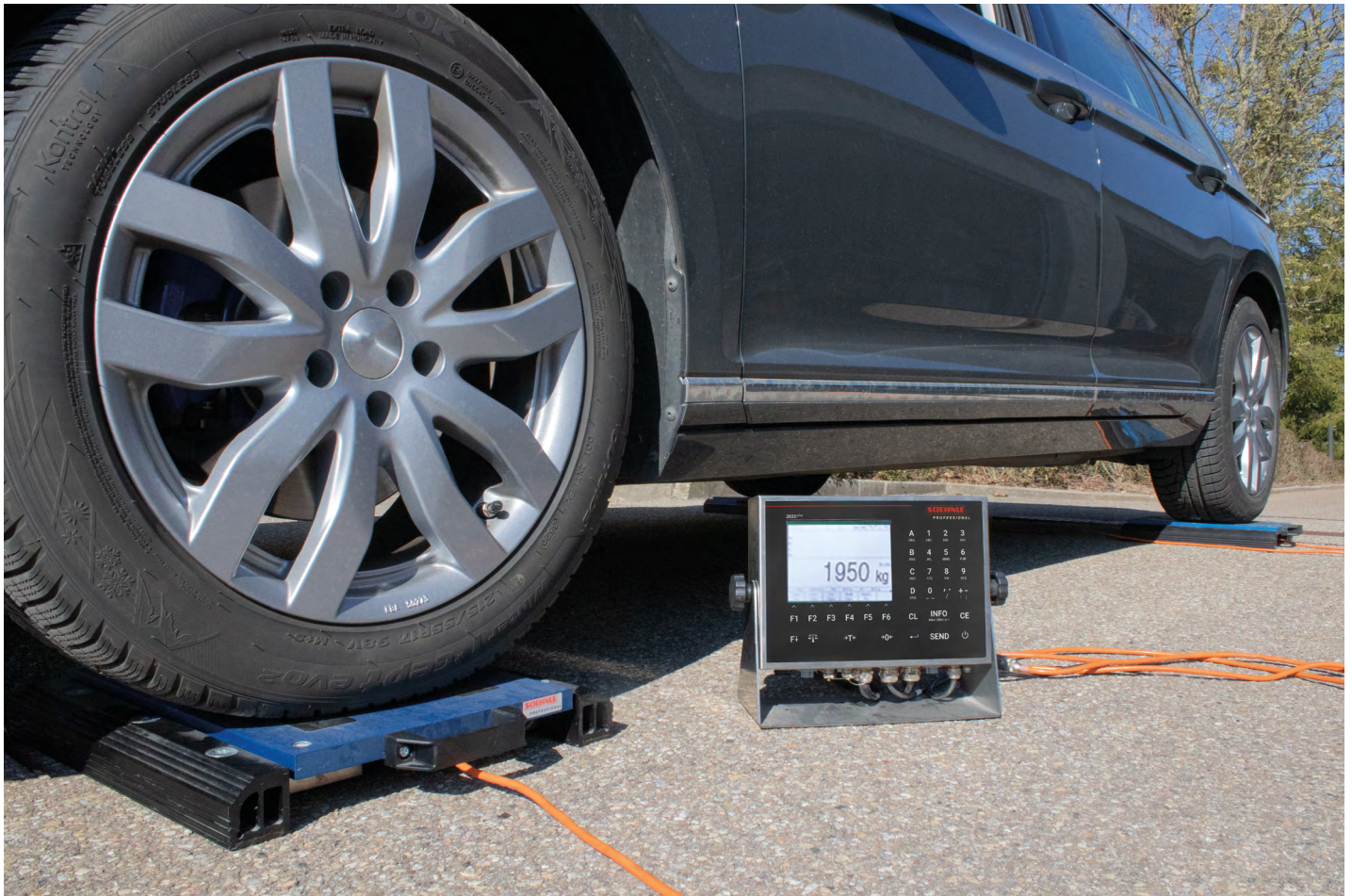
Beispiel: 4 Lastplatten steckbar als Gesamtgewichtswaage
